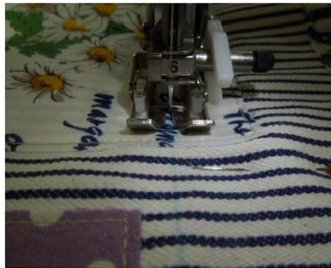
将绗缝导线杆插在同步压脚上。
