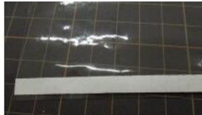
将水溶性两面胶带贴在 离PVC边缘1mm处
